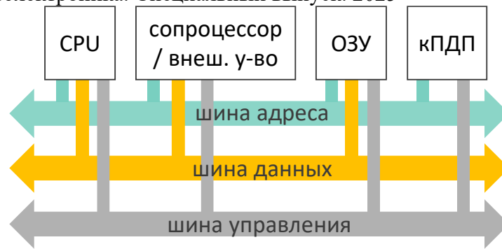
Рис. 3. Центральный процессор (CPU) обращается к ОЗУ для выполнения операций чтения и записи, управляя сигналами на шинах управления, адреса и данных. С помощью контроллера прямого доступа к памяти (кПДП) сопроцессор или внешнее устройство может выполнять аналогичные операции в обход CPU для ускорения работы.
