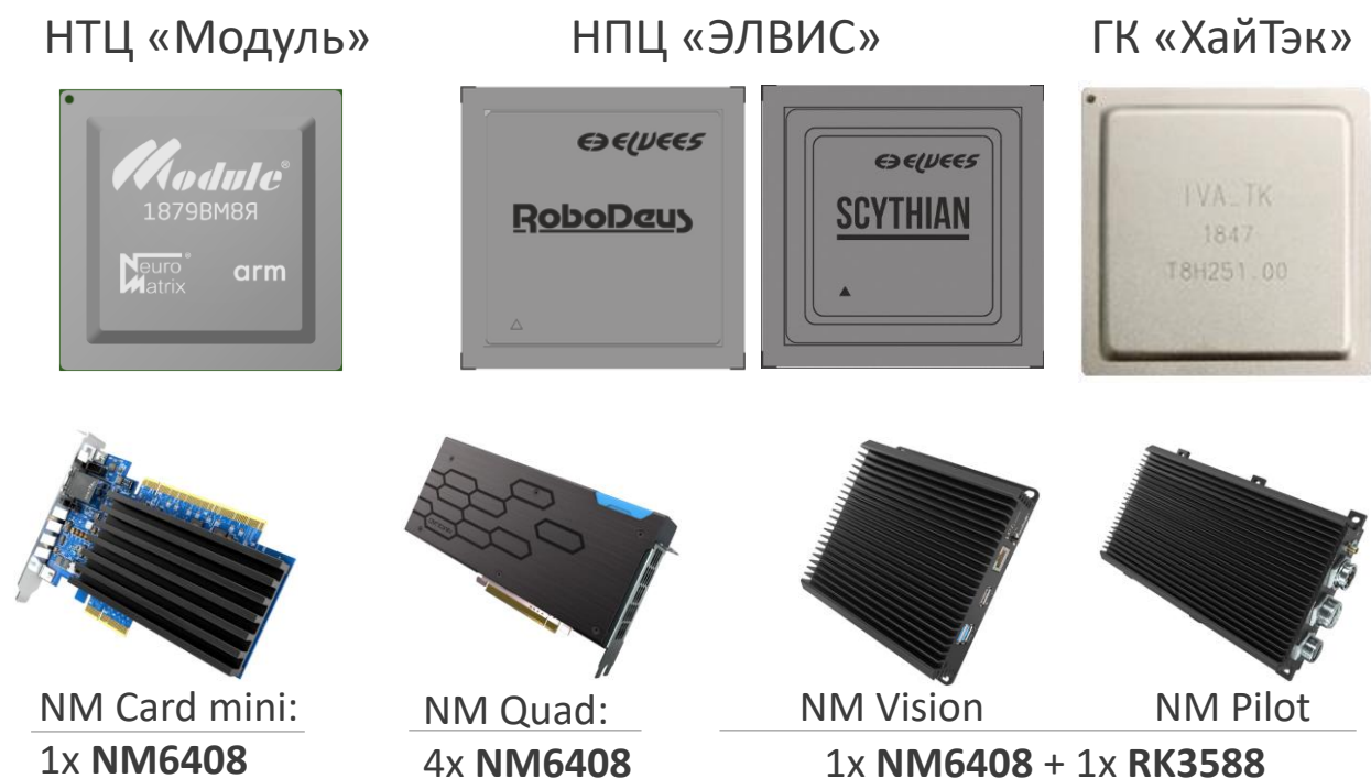
Рис. 5. Отечественные процессоры для нейросетей (верхний ряд): 1879BM8Я или NM6408 (НТЦ «Модуль»), RoboDeus и СКИФ (НПЦ «ЭЛВИС»), IVA TPU или H1 («ХайТэк»); решения на основе NM6408 и RK3588 (нижний ряд): модули NM Card mini и NM Quad, блоки NM Vision и NM Pilot
